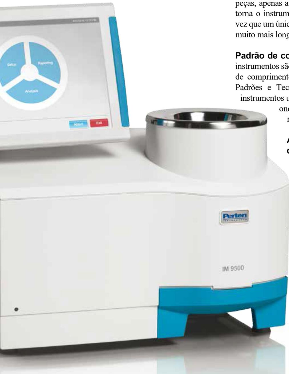
**O IM 9500** usa a transmissão de infravermelho próximo padrão para analisar amostras, mas inova com vários componentes-chave. Como resultado, ele é mais preciso, mais estável ao longo do tempo e exige menos manutenção do que outros analisadores.
