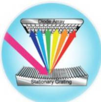
**Robusto e reproduzível.** A tecnologia de arranjo de diodo permitiu a criação de um instrumento sem componentes ópticos móveis, melhorando a precisão e estabilidade, o que significa que o hardware pode ser padronizado minimizando as diferenças de instrumentos. O DA 7250 estabelece novos padrões de transferência de calibração e também remove as fontes de possíveis falhas, pois não há monocromadores caros para desgastar nem espelhos flutuantes que podem ficar sujeitos à vibração.
